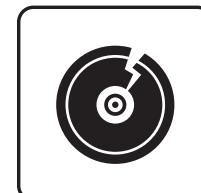
Используйте только качественные, неповрежденные шлифовальные круги. Не используйте шлифовальные круги сильно изношенные или с видимыми механическими повреждениями (сколы, трещины).
