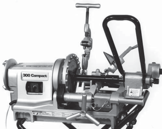
Рисунок 20 – Желобонакатчик №916 и переходник установлены на станок №300
