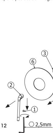
**D****INSTANDHALTUNG****ERSETZEN DES EINGEBAUEN TANKABLENKERS**
