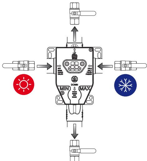
**I - Il tappo protezione in plastica sopporta pressioni idriche esclusivamente il tempo necessario per collaudare l'impianto. Dopo il collaudo, **non** lasciare in pressione l'impianto fino all'avvenuta installazione delle parti esterne.**
