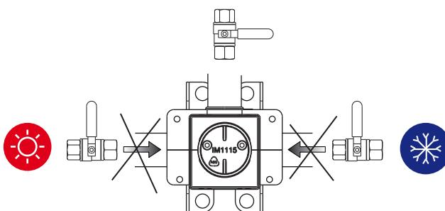
**I -** Il tappo protezione in plastica sopporta pressioni idriche esclusivamente il tempo necessario per collaudare l'impianto. Dopo il collaudo, **non** lasciare in pressione l'impianto fino all'avvenuta installazione delle parti esterne.
