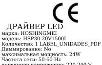
первичное напряжение: 220-240 V Тип: Corriente constante ток вторичной цепи: 1.500 V
