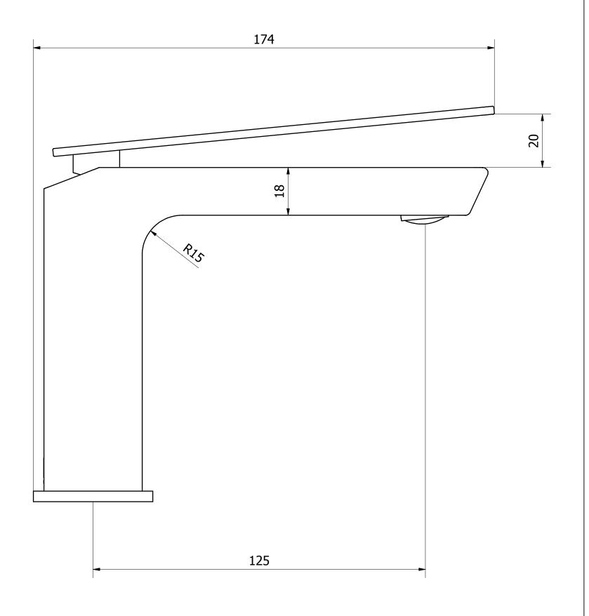
Foro sanitario: MAX Ø35 mm Basin hole MIN Ø30 mm
