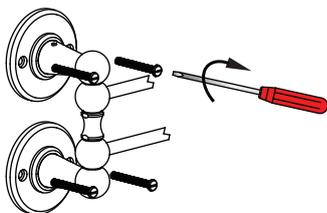
Fixez la base au mur en utilisant les vis en acier inoxydable. Veuillez vous assurer que la tête des vis soit parallèle au sol. sol.
