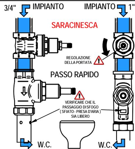
**PER UNA CORRETTA INSTALLAZIONE DI UN PASSO RAPIDO SI DEVONO EQUILIBRARE LA PRESSIONE A MONTE (IMPIANTO) E QUELLA A VALLE (W.C.)**
