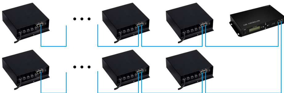
Рис 2. Slave-контроллеры подключаются к двум портам Master-контроллера.
