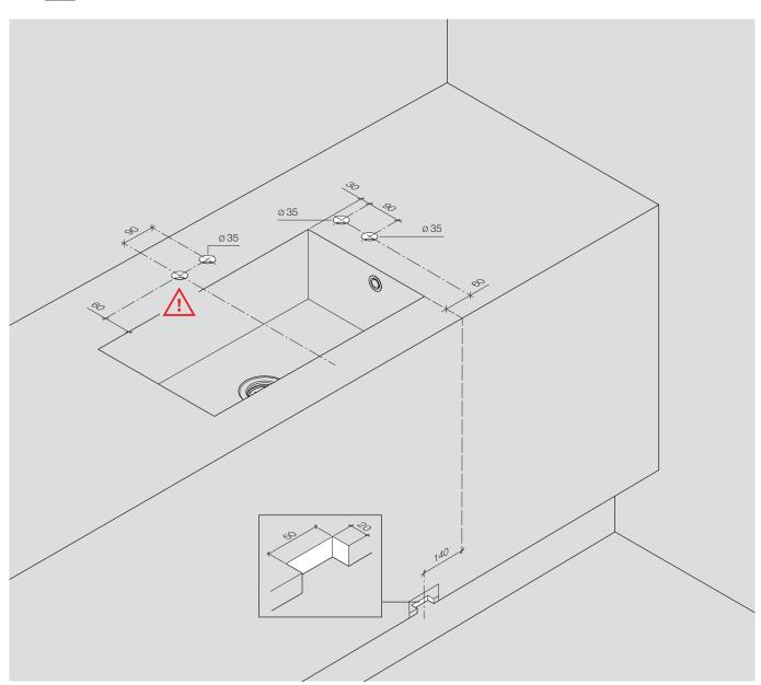
原则上我们建议在操作元件和池壁之间至少保留 60 mm 的间隙。台面在安装孔区域允许的最大厚度为 45 mm。 如果超过 45 mm 的最大厚度,则必须在孔洞下方稍加切削,直径至少为 50 mm。
