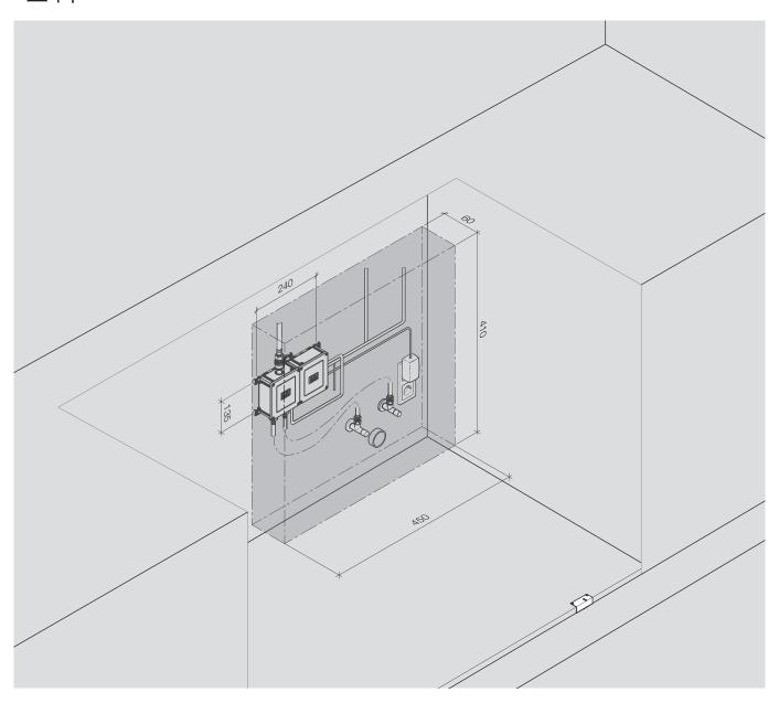
本安装示例指出控制单元和连接组件所需的最小空间。
