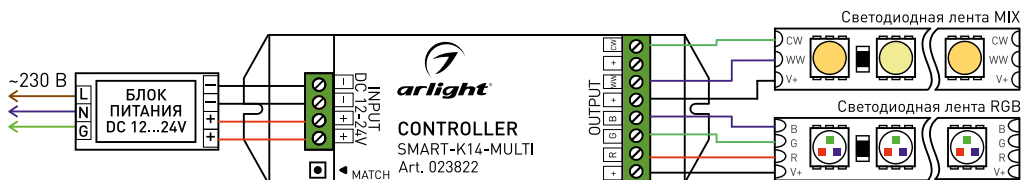
Рисунок 1. Схема подключения контроллера.
