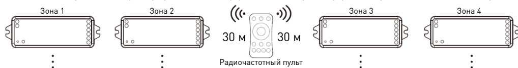
Рисунок 3. Расположение контроллеров в различных зонах.
