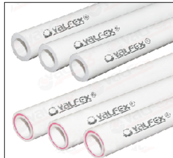
Трубы PPR и трехслойные стеклонаполненные (средний слой армирован стекловолокном) (PP-R/PP-R GF/PP-R) не требуют специальной подготовки к сварке.
