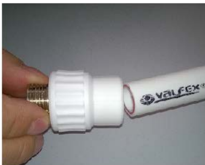
До выполнения соединения следует проверить качество трубы и фитинга. Для этого надо попробовать ввести трубу в гнездо фитинга. Труба в него не должна входить. Если труба свободно входит в гнездо, то качественного сварного соединения не получится.
