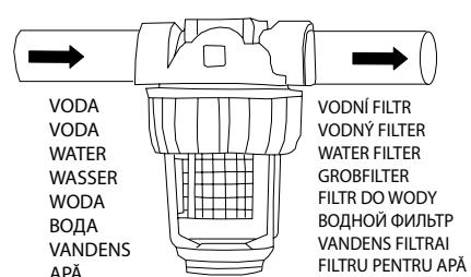
Na přívodu vody musí být nainstalován vodní filtr!
