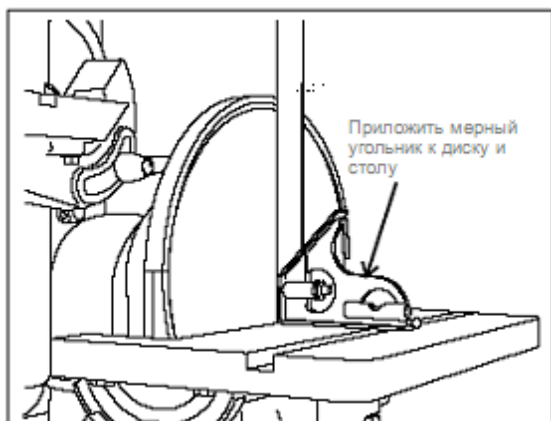
Рис. 15: Использование угольника для проверки угла.
