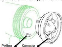
Рис.8 Сборка распылителя
