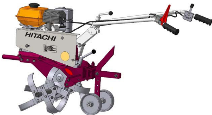
Рис.10 Схема транспортировки мотокультиватора на опорных колесах.
