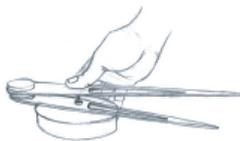
Introducir el eje de la aguja minuterá en el cañón de la máquina y presionar hasta el fondo.
