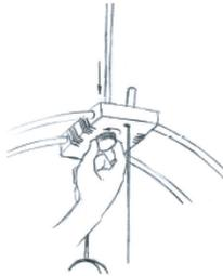
Colgar el reloj pasando la varilla (f) por el agujero central de la pieza de madera (a) utilizando la tuerca para colgar (g).
