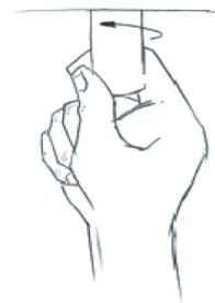
Fijar el anclaje techo (h) con el taco y el tornillo. Enroscar la varilla (f) con la longitud deseada al anclaje techo (h).
