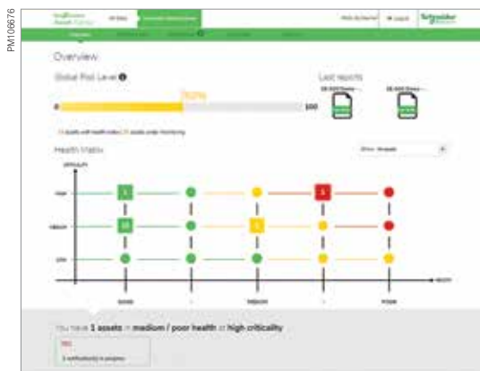
Матрица технического состояния в Asset Advisor
