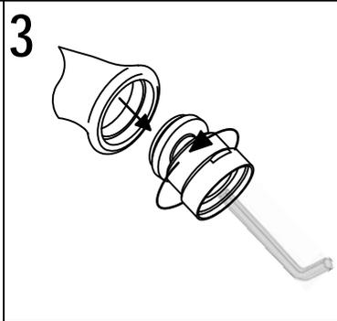
**SOSTITUZIONE VITONE / VALVE REPLACEMENT**
