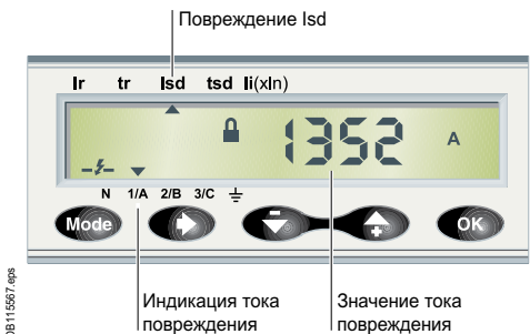
Индикация тока повреждения
