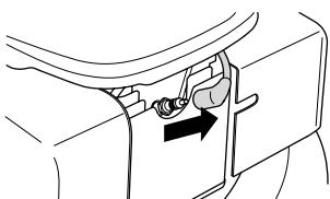
Прежде чем положить газонокосилку в положение «на бок» слейте топливо из топливного бака.
