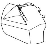
Ανασηκώστε το πλευρικό κάλυμμα και τοποθετήστε το σύστημα πλευρικής αποβολής στον άξονα.
