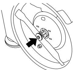
Для замены ножей или крепления необходимо также заменить винт, шайбу и пружину колпака.
