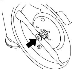
Шайбата и пружината трябва винаги да се подменят при смяна на резеца или на скобата на резеца.
