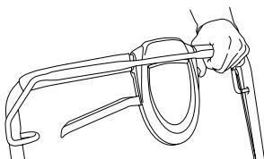
Πιάστε με το δεξί χέρι τη λαβή του μηχανισμού εκκίνησης, τραβήξτε αργά το κορδόνι μέχρι να βρείτε αντίσταση (να πιάσουν τα δοντάκια του μηχανισμού εκκίνησης) και μετά τραβήξτε γρήγορα και δυνατά το κορδόνι. **Ποτέ μην τυλίγετε το κορδόνι εκκίνησης στο χέρι.**
