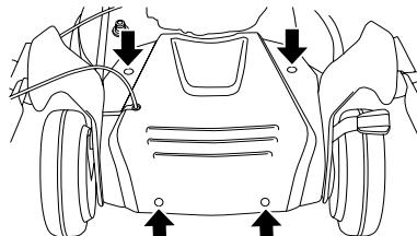
Το κάλυμμα κοψίματος έχει σχεδιαστεί για τη μείωση των δονήσεων και τη μείωση του κινδύνου κοψίματων. Βεβαιωθείτε ότι το κάλυμμα κοψίματος δεν παρουσιάζει βλάβες και ότι δεν υπάρχουν ορατά ελαττώματα, όπως ρωγμές.
