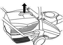
Τοποθετήστε το βύσμα κοπής χορτολιπάσματος στο κανάλι του συλλέκτη.
