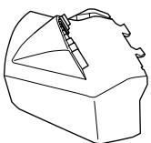
Поднимите боковую крышку и установите боковой извлекатель на вал.
