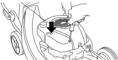
Αφαιρέστε το φίλτρο αέρα και ελέγχετε ότι δεν παρουσιάζει βλάβες. Αντικαταστήστε με ένα νέο φίλτρο αέρα, αν πιστεύετε ότι είναι ελαττωματικό.
