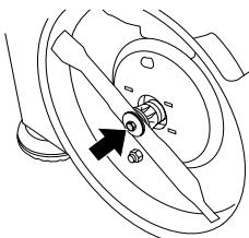
Ако резецът или скобата на резеца трябва да бъдат подменени, то трябва да смените болта на резеца, шайбата и пружината заедно.
