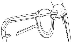
Хванете дръжката на стартера и изтеглете бавно стартерния шнур с дясната ръка до положение, когато усетите съпротива (зъбците на стартера зацепват), след което издърпвайте шнура с бързи и силни движения. Не бива никога да навивате стартерния шнур около ръката си.
