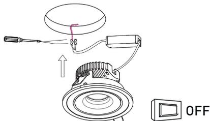
Подключите провода сети питания к драйверу светильника, затем уберите драйвер в запотолочное пространство, отогните вверх пружинные ушки светильника и установите его в отверстие.
