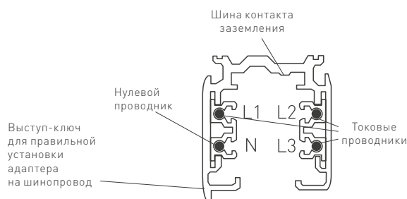
Рисунок 1. Конструкция шинопровода
