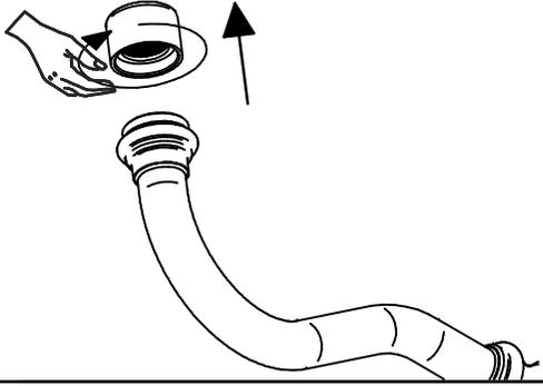
**SOSTITUZIONE VITONE / VALVE REPLACEMENT**
