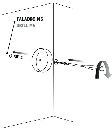
Dependiendo del tipo de superficie, la caja central del reloj podrá ser atornillada a la pared, o mediante el adhesivo incluido, pegada a la pared.
