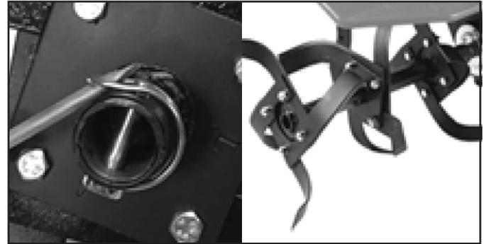
8.6 Снимите колеса (если они были установлены) и установите фрезы, для этого с помощью отвертки извлеките стопор и снимите колесо, установите фрезы и зафиксируйте стопор.
