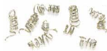
Свободно намотанная (витая) стружка идеальные условия резания
