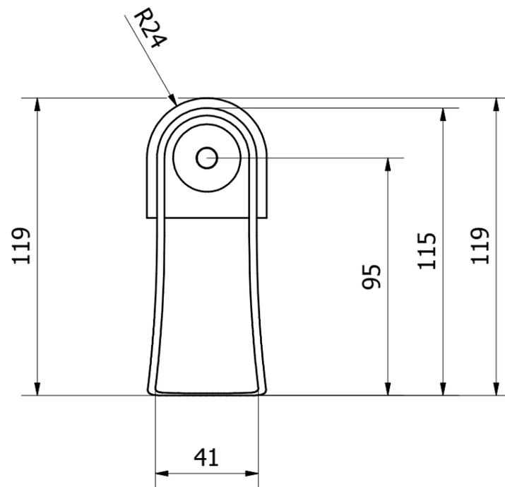
Foro sanitario con bassetta: MIN Ø30 mm
