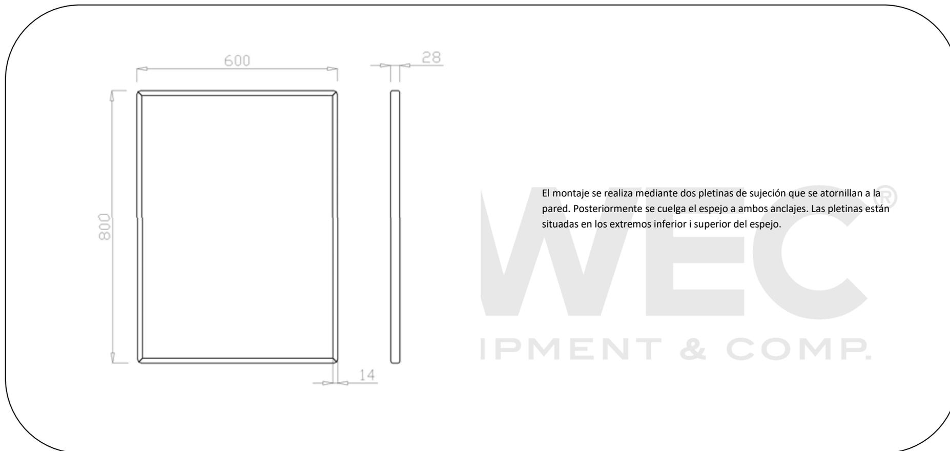
El montaje se realiza mediante dos pletinas de sujeción que se atornillan a la pared. Posteriormente se cuelga el espejo a ambos anclajes. Las pletinas están situadas en los extremos inferior i superior del espejo.
