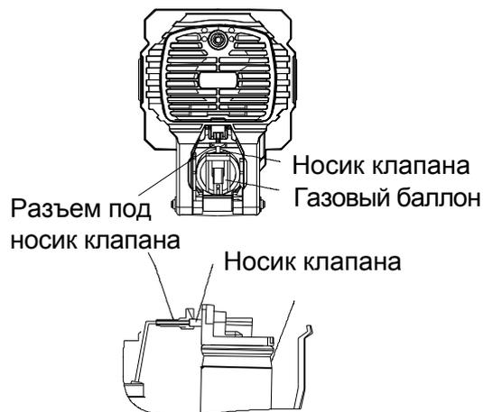
4. Закройте крышку отсека баллона.
