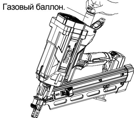
3. Установите баллон так, чтобы носик клапана попал в специальный разъем.
