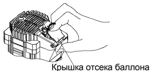
5. Закройте затвор крышки отсека баллона.
