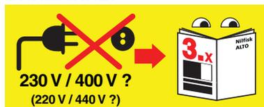
Перед тем, как подключить устройство к сети, обязательно проследите за тем, чтобы у моечных машин с возможностью переключения напряжения было выбрано правильное напряжение. В ином случае это может привести к повреждению электрических элементов мойки.
