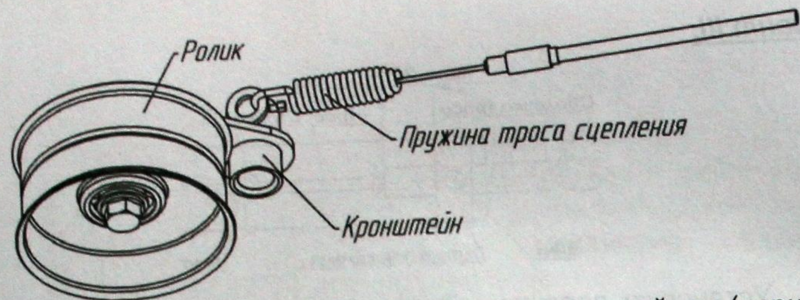
Рис.6. Схема зацепления троса сцепления с кронштейном (вариант 1)
