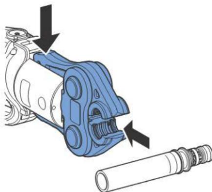
يجب إعادة كبس وصلة الضغط ما لم يتم كبسها تمامًا، مثلًا عند انقطاع التيار. تتم إعادة الكبس مثل أية عملية ضغط عادية. عند إعادة الكبس فمن الممكن أن تقوم ماكينة الكبس بشروط خامل كبير قبل البدء بعملية الكبس، حيث إن ذلك متوقف على عملية الكبس السابقة.
