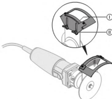
**1** Flügelmuttern lösen, bis Schutzausrüstung locker ist
