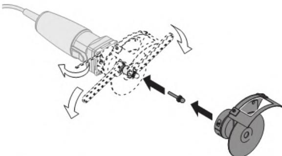
**6** Spænd spændetangen
