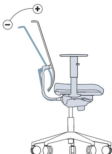
Регулировка наклонного натяжения
