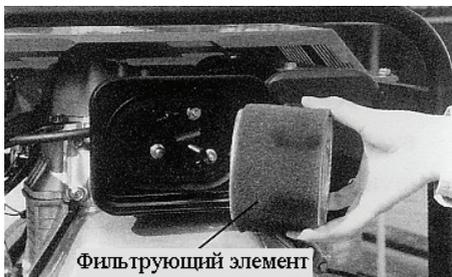
Рис.11. Обслуживание воздушного фильтра
