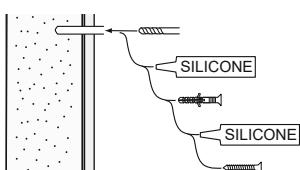
Skruvinfästningar i våtzon 1 ska göras i betong eller annan massiv konstruktion, träreglar, tråkortlinger eller i konstruktion som är provad och godkänd för infästning, till exempel skivkonstruktion. Se exempel på godkända konstruktioner på säkervatten.se.
