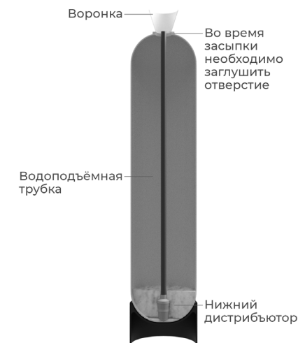
Заполнение фильтра материалом
