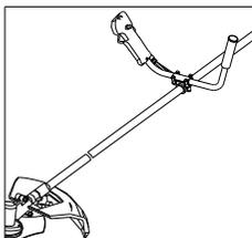
Возьмите ручку и установите её в специальную скобу для ручки. Затяните скобу для ручки при помощи 4 крепёжных винтов, поставляемых в комплекте, и слегка их затяните. Прикрепите ручку на шток в удобную рабочую позицию, затем туго затяните крепёжные винты.
