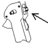
Залейте бензин в карбюратор медленным нажатием кнопки подкачки несколько раз до тех пор, пока бензин не поступит в карбюратор.
