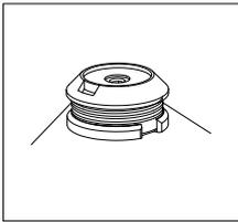
Прикрутите шпулю с леской против часовой стрелки (в левую сторону) по резьбе штока в конце приводной части. Зафиксируйте шток на месте, вставив отвёртку или ключ-шестигранник в отверстие в верхнем зажиме насадки и крепко затянув винт.
