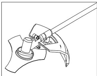
Защитный кожух должен крепиться к опорной части, возле привода при помощи четырёх винтов и двух пластин.
