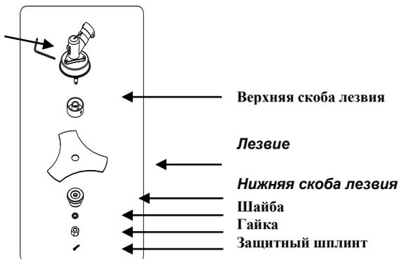
Выньте шплинт, открутите гайку по часовой стрелке (в правую сторону) и снимите нижнюю скобу лезвия.
