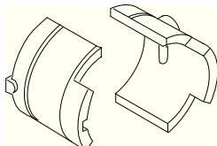
Регулярно проверяйте, чтобы на виброгасящих элементах не было трещин или деформаций.
