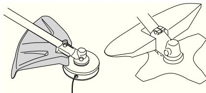
Проверьте, чтобы защита не была повреждена и чтобы на ней не было трещин. Замените защиту, если она была подвергнута удару или если на ней есть трещины.
