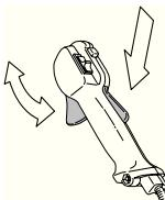
См. указания в разделе Запуск. Включите машину и полностью откройте дроссель. Отпустите рычаг дросселя и удостоверьтесь, что режущее оборудование останавливается и остается неподвижным. Если после постановки дросселя в положение холостого хода режущие оборудование продолжает вращаться, следует проверить регулировку холостого хода
