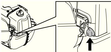
Заслонка топлива: Установите заслонку топлива в положение сътнения.
