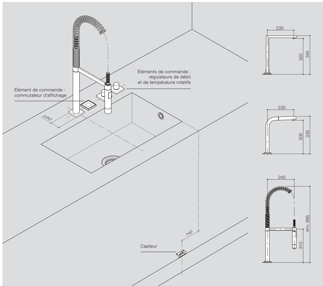
Ce positionnement est recommandé. Dans l'idéal, la longueur minimale de l'évier est de 600 mm. Par principe, le bec déverseur et les éléments de commande de l'eUNIT KITCHEN peuvent être positionnés librement. Il est conseillé aux gauchers de disposer ces éléments de façon inversée.
