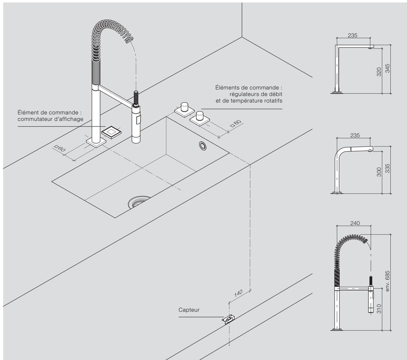
Ce positionnement est recommandé. Par principe, le bec déverseur et les éléments de commande de l'eUNIT KITCHEN peuvent être positionnés librement. Il est conseillé aux gauchers de disposer ces éléments de façon inversée.
