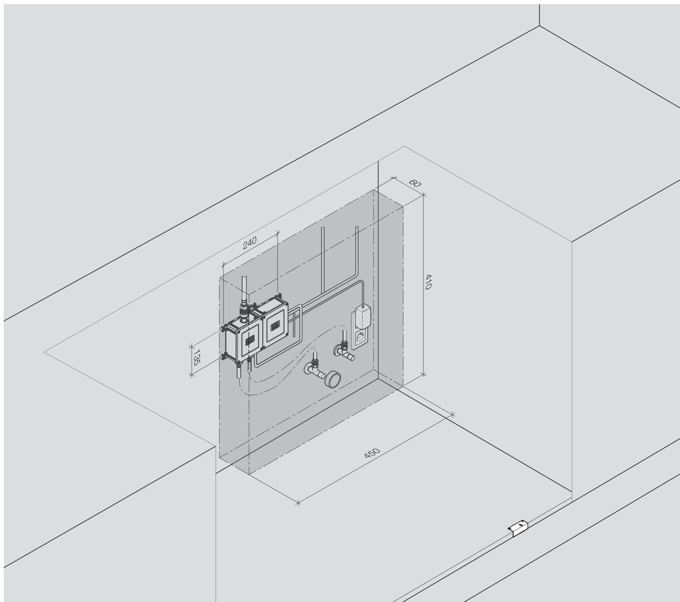
Cet exemple de montage montre l'espace minimal requis pour l'unité de commande et les composants de raccordement.
