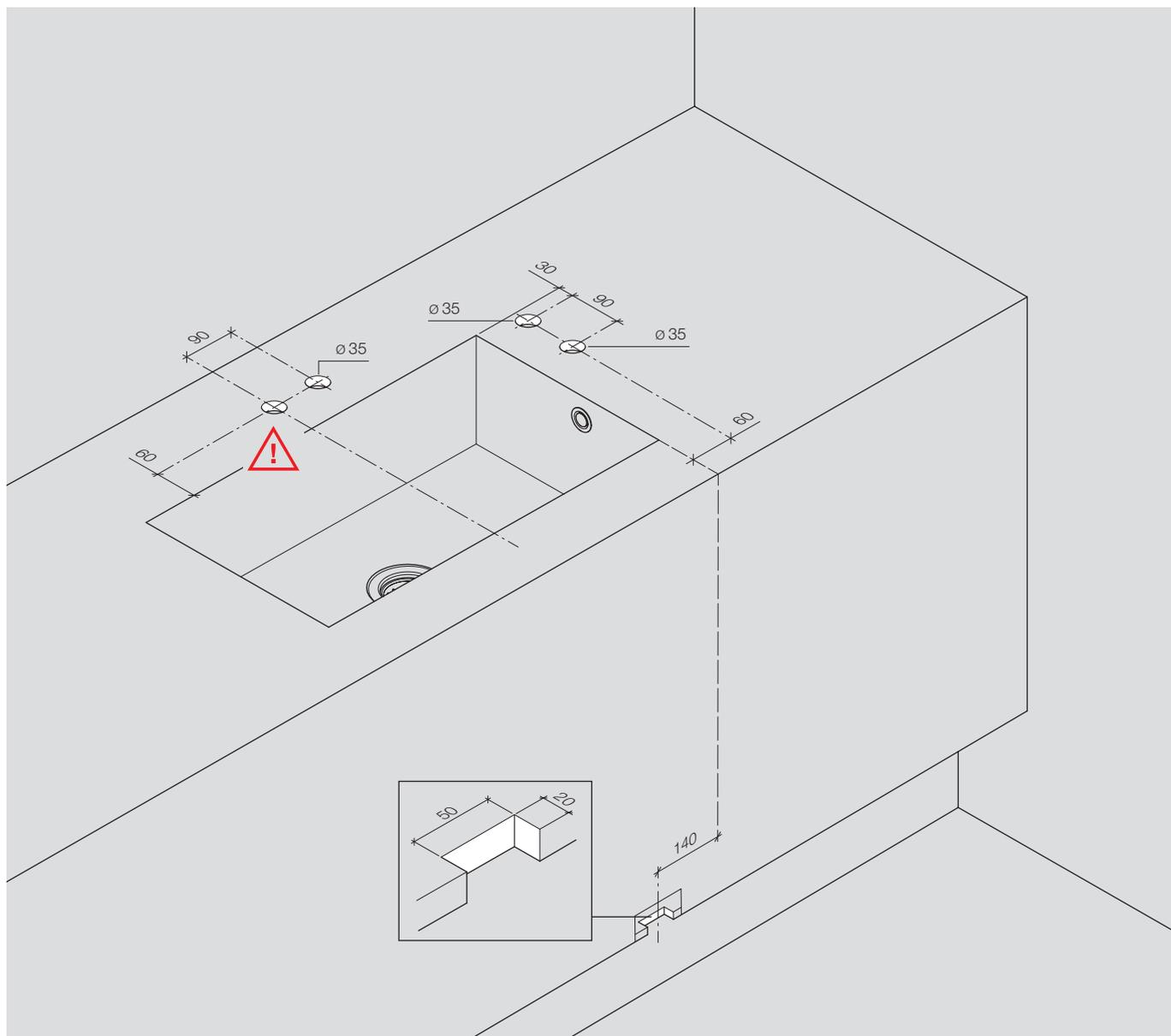
Par principe, nous recommandons un écart minimal de 60 mm entre l'élément de commande et le bord de l'évier. L'épaisseur du plan de travail ne doit pas dépasser 45 mm au niveau des orifices de montage. En cas de dépassement, le diamètre minimal de la fraisure inférieure correspondante doit être de 50 mm.
