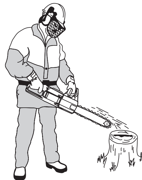
Рисунок 11 — Контроль устройства автоматической смазки режущей гарнитуры
