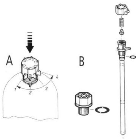
Удалите давление в воздушной камере, открыв ручной клапан (прижав ручку). Давление регулируется до наполнения бака раствором. Для этого нужно нажать регулятор (A) вниз и повернуть его, установив в одном из четырех положений (совместив выбранный маркированный цифрами 1, 2, 3, 4 выступ регулятора с выступом на корпусе воздушной камеры).
