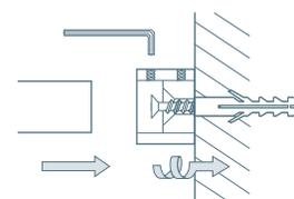
Ohne Wandlager ist eine direkte Verschraubung in optisch reduzierter Form möglich: Die Stangenenden werden mit zwei M6 Innengewinden und mittels M6 Stockschrauben verschraubt
