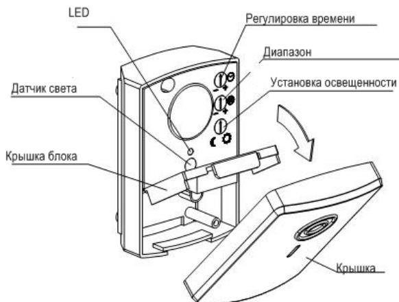
Датчик присутствия Ecomat может обнаруживать малейшие движения, производимые в зоне обнаружения, благодаря используемой высокочастотной технологии (5,8 ГГц). Его чувствительность не зависит от температуры окружающей среды. Прибор сразу обнаруживает перемещение любых предметов, даже таких как стулья, двери и т.д. Область обнаружения Ecomat составляет от 0,5 до 6 м впереди прибора и 3 м по бокам. Угол обнаружения составляет 270°.
