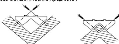
После того как кронштейн закреплен на стене в нужном месте, Ecomat должен быть установлен в положение как на рисунке, пока не будет полностью закреплен.
