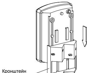
Снимите крышку, слегка потянув на себя нижнюю ее часть, и ослабьте крепежный винт соединения, для доступа к клеммной колодке.
