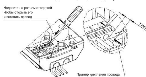
Пропустите соединительные провода через полость в нижней части устройства или через его тыльную поверхность (см. рисунок). Подключение производится по следующей схеме:
