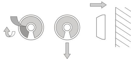
**⚠ HINWEIS** Die Endklebekraft wird nach ca. 72 Stunden erreicht. Dann ist das Produkt maximal belastbar.
