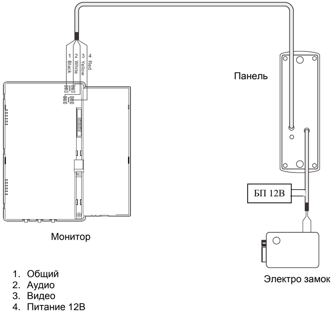
Подключение вызывной панели может производиться, как к винтовым контактам, так и к 4-х проводному шлейфу с разъемом. Назначение контактов разъема следующее:
