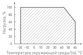
Рис. 1. Максимальная допустимая нагрузка, % от мощности источника.
