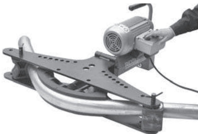
Рис.14 - Работа на электрической гибочной машине
