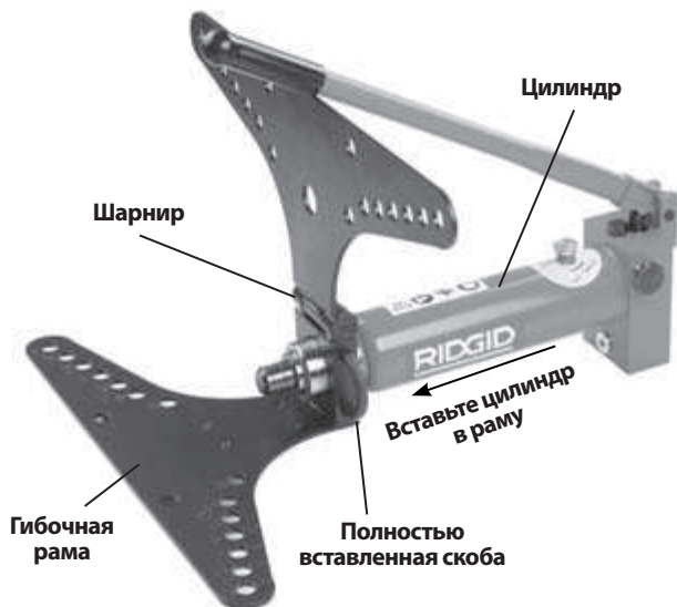
Рис.5 – Сборка 2" и 3" гибочных машин
