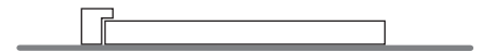
sopra pavimento con elemento speciale salva acqua on floor installation with special water save rail
